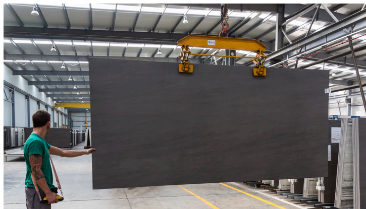
Immagine 2: lastra Neolith spostata con pinza di sollevamento
