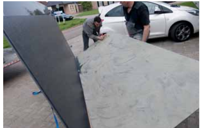
05 Fully gluing of the slab 05 Incollaggio completo della lastra
